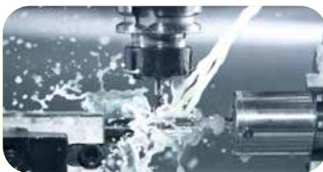
Per il controllo dell'emulsione da effettuarsi periodicamente con Rifrattometro/Oleometro con scala 0÷20 il coefficiente rifrattometrico è: 1.74. Esempio: se la lettura al rifrattometro per il controllo del LUBRIS è uguale a 2 vuol dire che la percentuale di prodotto presente nell'emulsione sarà del  $2 \times 1,74 = 3,48 \%$
